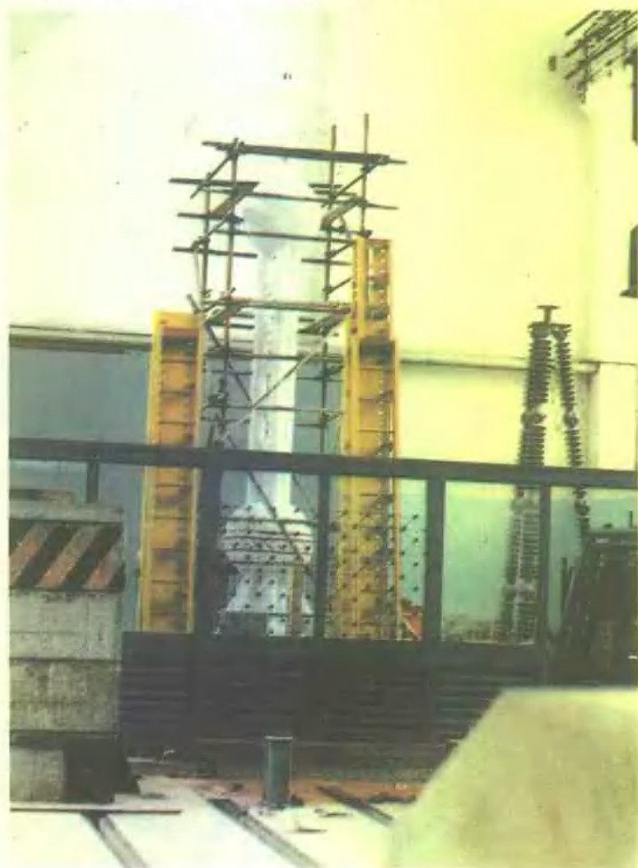
同济大学实验室作东方明珠模型抗震试验
