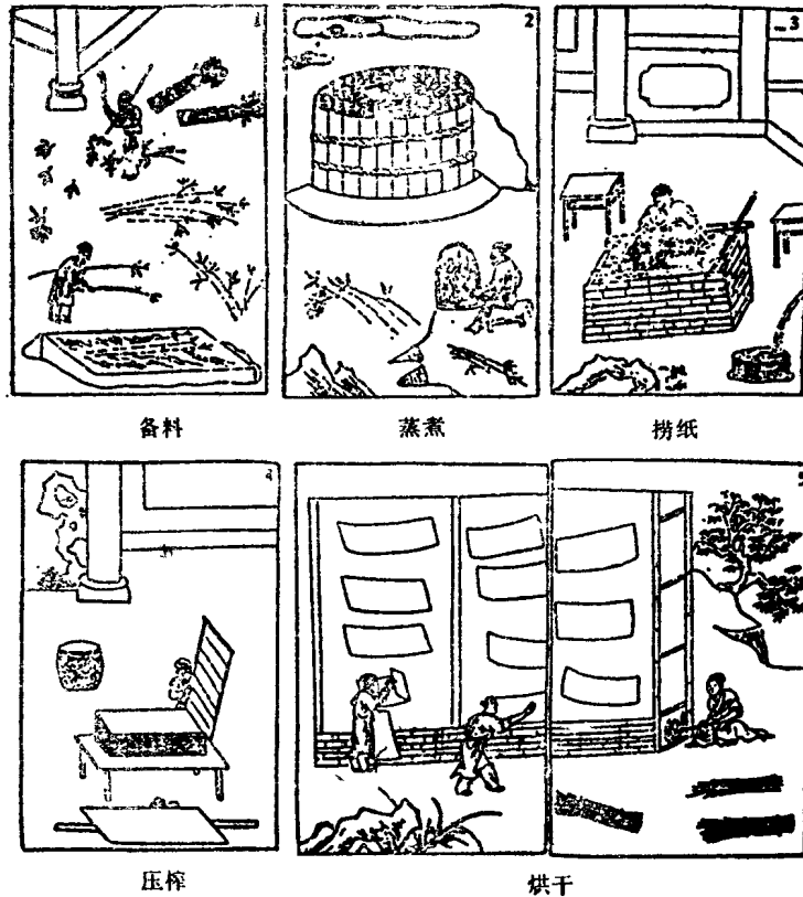
图 1-2 手工造纸主要操作示意图
