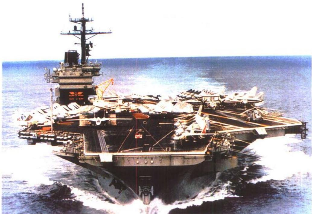
该舰满载排水量81123吨，舰长318米，舰宽39.6米，航速32节，能连续航行8000海里，装备8台锅炉蒸汽动力装置，编制3200人，另有航空联队2480人。搭载各类飞机90架。另装备导弹、火炮、电子战武器多种。“小鹰”级航空母舰目前有4艘在役。“小鹰”级服役30多年来，多次参战。1964年，“小鹰”级2号舰“星座”号直接参与了导致美国正式介入越南战争的北部湾事件；1979年，首舰“小鹰”号曾参加美国营救伊朗人质的行动；1986年4月，3号舰“美国”号与“珊瑚海”号和“萨拉托”号航空母舰一起突破死亡线，用舰载机对利比亚的陆、海目标进行了攻击。
