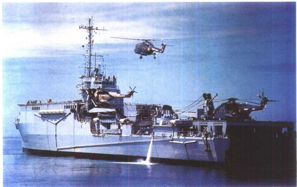
该级舰共建有2艘，首舰“暴风”号于1965年服役，后续舰“暴风雨”号于1968年服役。各舰均有登陆艇及直升机，可载2艘步兵坦克登陆艇或18艘机械化部队登陆艇。飞行甲板可载4架中型飞机或8架轻型直升机。
