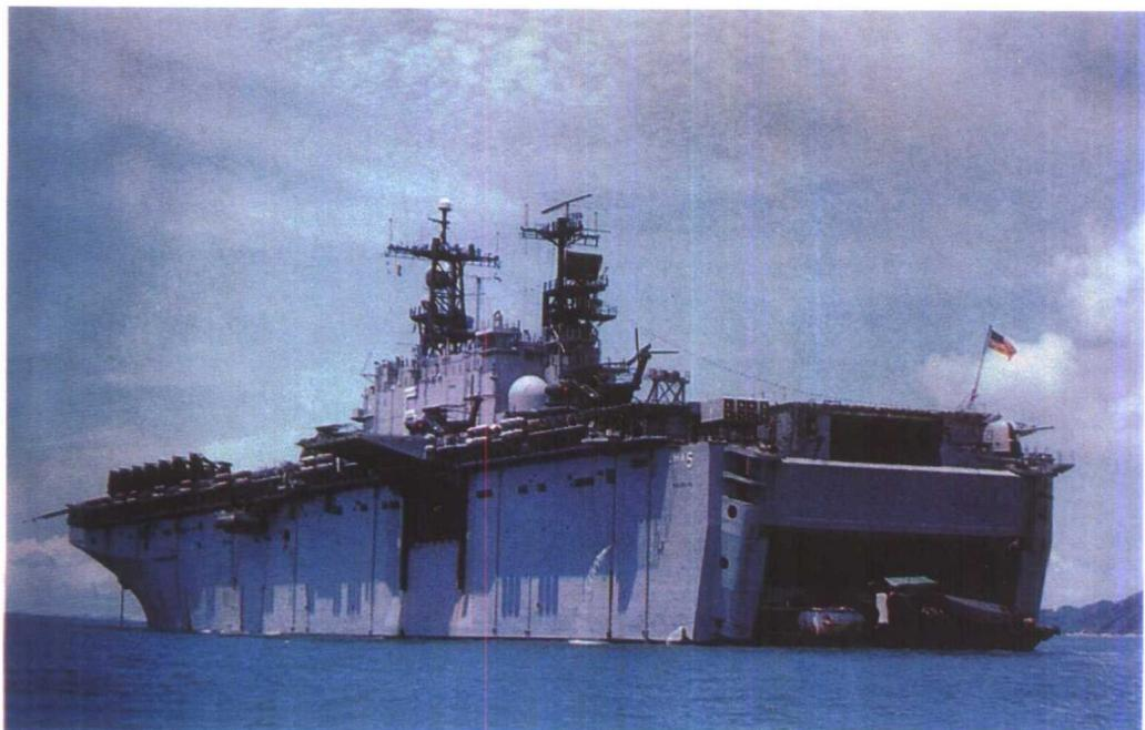
续航力1000海里。装备20多架各型飞机，有2座8联装“海麻雀”导弹发射装置，3座127毫米火炮和2座“密集阵”火炮系统及6座20毫米炮。编制935人，舰上还设有一个拥有300张床位、3个手术室的医院。
