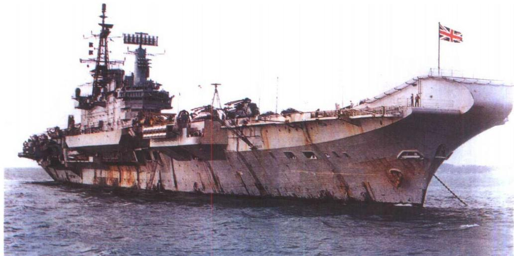
国德文波特船厂进行了改装和全面大修，1987年5月正式编入印度海军服役。该舰满载排水量28700吨，舰长226.9米，舰宽48.8米，航速28节。编制人员1350人。装备各类飞机14架另有苏制防空导弹和电子战兵器。
