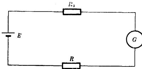
**解** 测量电阻  $R$  是通过显示在电流计  $G$  上的电流值来实现的。设  $G$  的满度电流为  $I_0$ ，则  $I_0 = E/R_0$ 。接上电阻  $R$  流经  $G$  的电流为  $I = E/(R+R_0)$ ，因此
