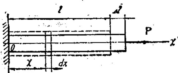
图 1-3 杆件轴向变形计算
