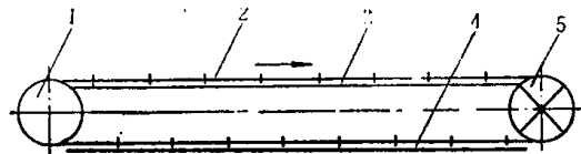
图0-3 刮板输送机的基本组成
