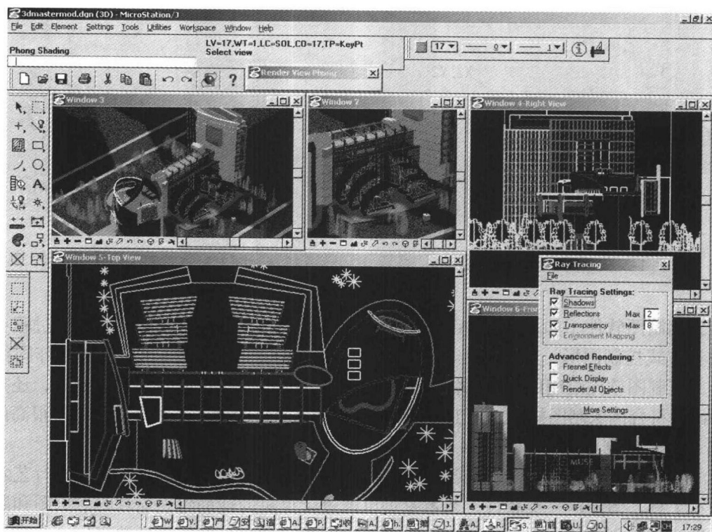
图 1-1 自带比较完整渲染功能的矢量工程绘图软件 MicroStation 的操作界面
