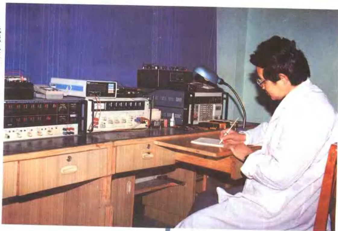
无线电室用S101A标准器检定数字式万用表
