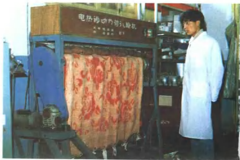
电器室电热毯检验
