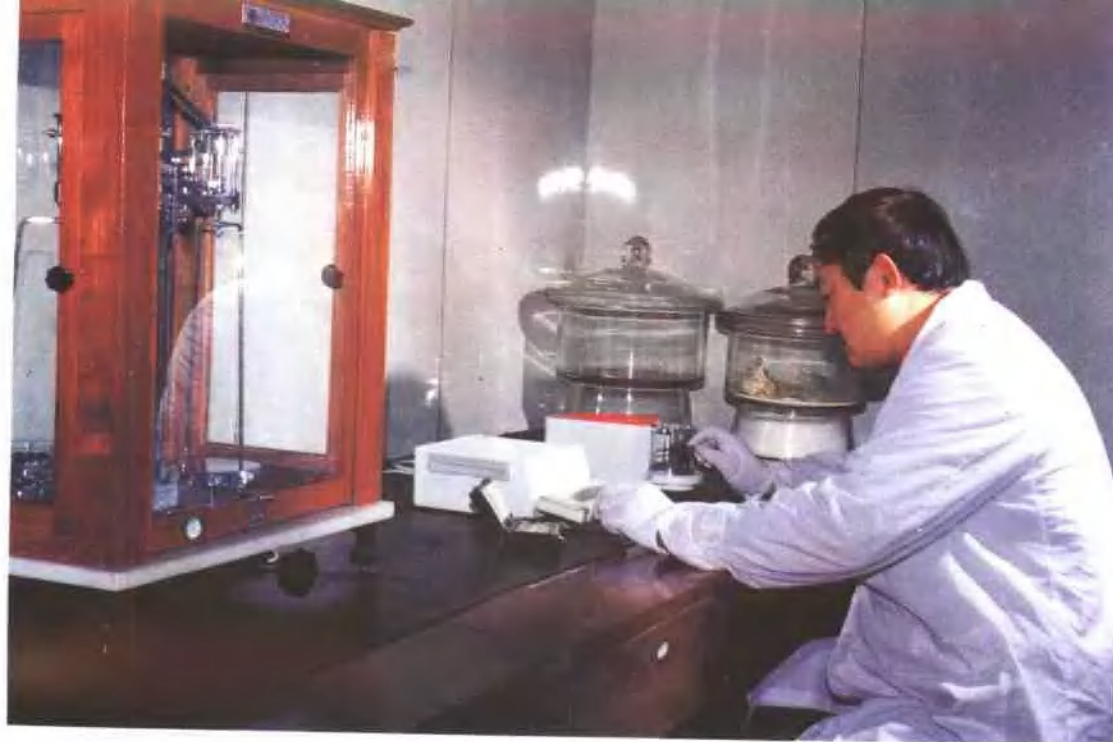
力学计量室用ZHS型微量电子天平检定二等砝码
