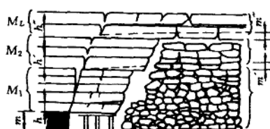
图 1-3 铰接岩块假说模型
