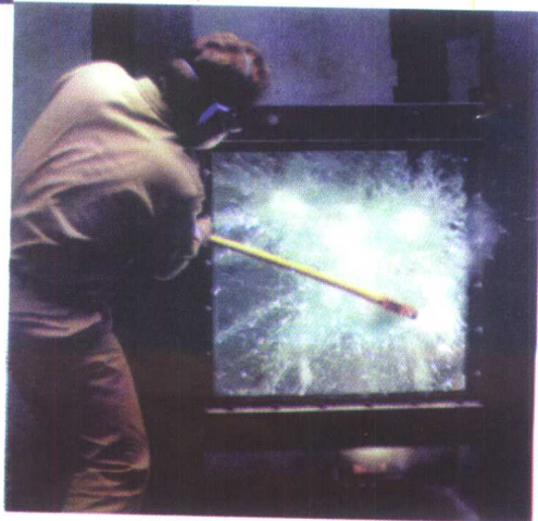
安全玻璃结构及其破坏实验
