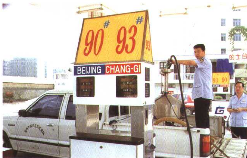
市稽查队进行加油机计量检定
