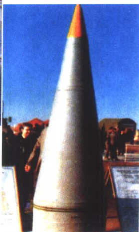
▷ 飞毛腿式战斗导弹化学弹， 内装胶粘 VX 毒剂555 千克
