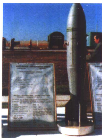
△ 250 千克化学航弹，内装胶粘梭曼 毒剂45 千克
