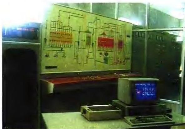
杭州市机械科学研究所研制成功的微机自动配料装置，获1989年国家科技进步奖
