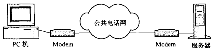
图 1-3 计算机通过调制解调器及电话线连网
