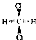
图 24-9 \text{CH}_2\text{Cl}_2 的透视结构式
