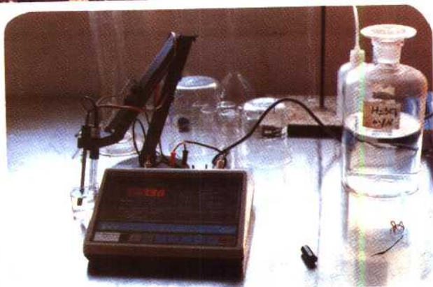
PH 值測定計，測定 地下水及 0.1N 之 \text{H}_2\text{SO}_4
