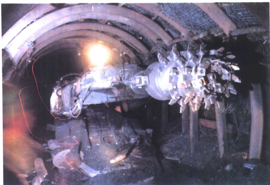
综合掘进机掘进工作面
