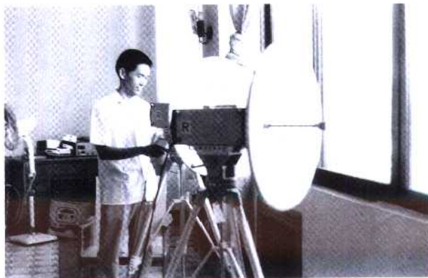
► 广西电视台节目传送中心小微波设备机房。图为接收电视转播车实况转播送来的信号。
