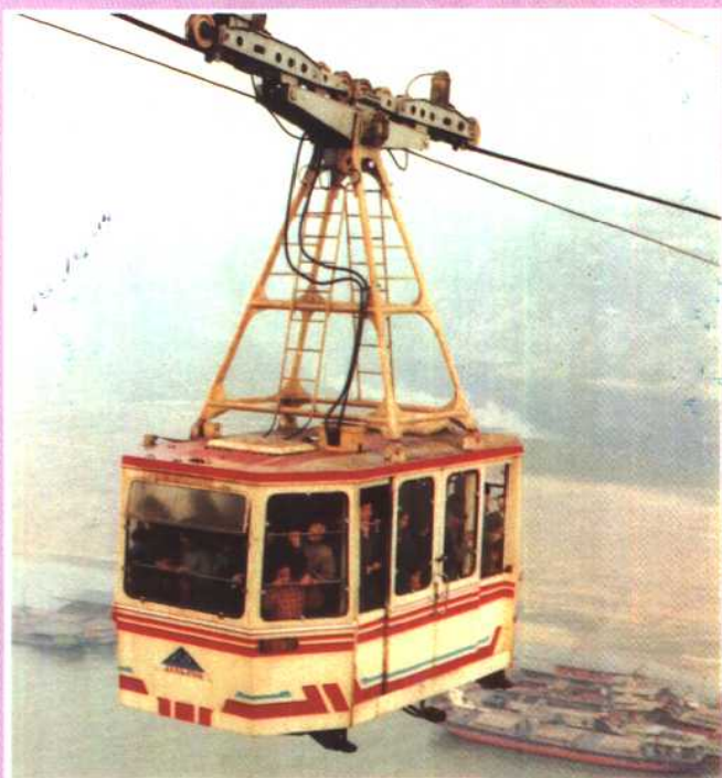
▲1983年1月，四川矿山机器厂制造的我国第一条往复式过江载人索道在重庆市嘉陵江上建成使用
