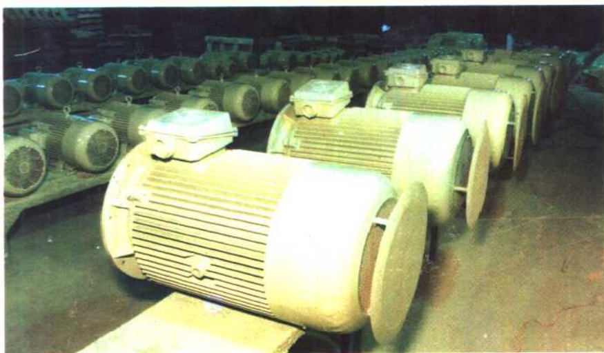
▲重庆电机厂80年代更新换代的Y系列小型三相异步电机
