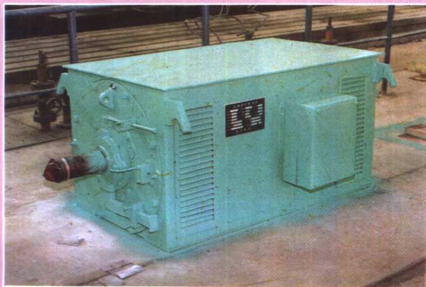
▲1984年,东方电机厂开发的X系列中型 高压新系列异步电动机,性能达到80年代国际 先进水平
