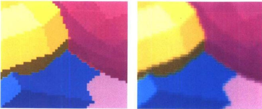
彩图 23. 前面场景的放大图。左边的图像显示了走样的、有锯齿的边。在右边的图像中，边被模糊化或者反走样处理，因此具有较少的锯齿。参见第 10 章。
