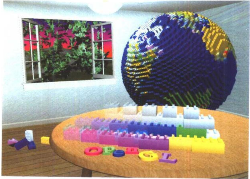
彩图 7. 其中一个物体采用运动模糊绘制的场景。使用累积缓存组成运动物体模糊所需的序列。 参见第 10 章。
