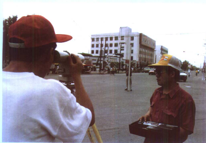
▲ 1975 年,新疆开始引进自动安平水准仪。图为测绘职工用自动安平水准仪进行水准测量。
