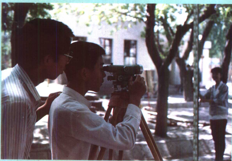
◀ 1990 年，新疆测绘职工在乌鲁木齐市进行水准仪检验。
