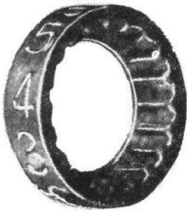
零件名称：号码齿轮侧向挤压（字母与内齿同时挤成）
