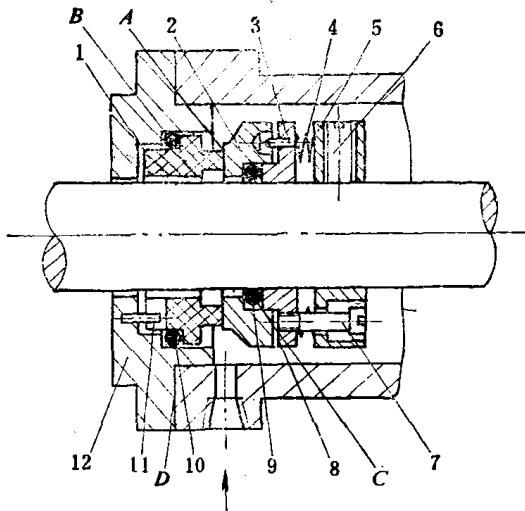
图1 机械密封的基本结构
