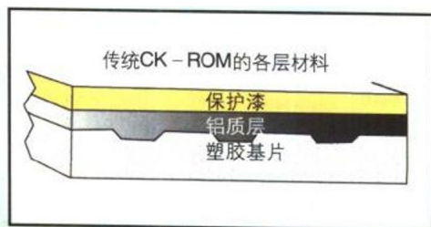
图 3/ 光盘的材质结构图
