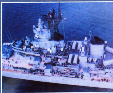
美国衣阿华级战列舰上加装的8个战斧巡航导弹发射箱的配置情况。
