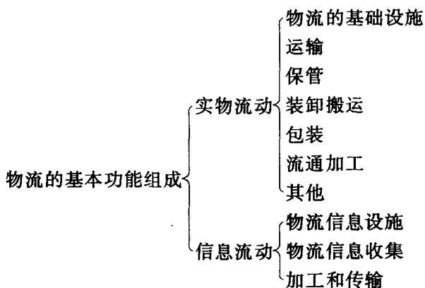
装卸搬运是对运输、保管、包装、流通加工等物流活动进行衔接的中心环节。该环节包括装车（船）、卸车（船）、堆垛、入库、出库以及连接以上各项动作的短程搬运。在物流活动的全过程中，装卸搬运工作是频繁发生的，因而可能是产品损坏的重要原因之一。对装卸搬运作业的管理，主要是对装卸搬运方式的选择、装卸搬运机械的选择和合理的配置与使用、装卸搬运作业过程的机械化、自动化和合理化以及尽可能减少装卸搬运的次数等。
