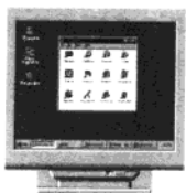
图 2.1 显示器外形 15 英寸、17 英寸、19 英寸和 21 英寸不等，这和我们家里的电视机屏幕大小是一样的。屏幕越大，图像显示的就越大。可是太大的显示器对眼睛有一定的伤害哦！
