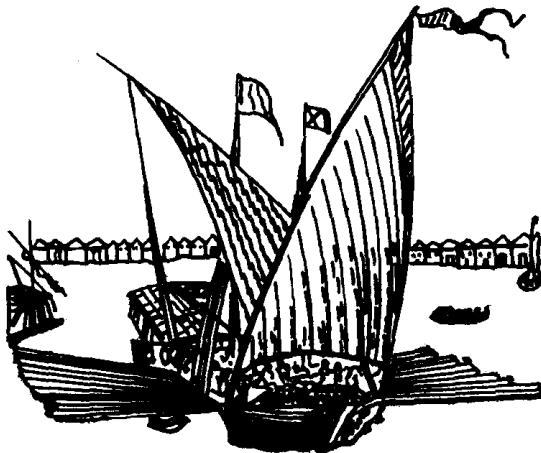
18世纪初叶俄国的轻型大挠战船，船首安装1~2门小口径炮，可载150名水手和进行接舷战的战士。
