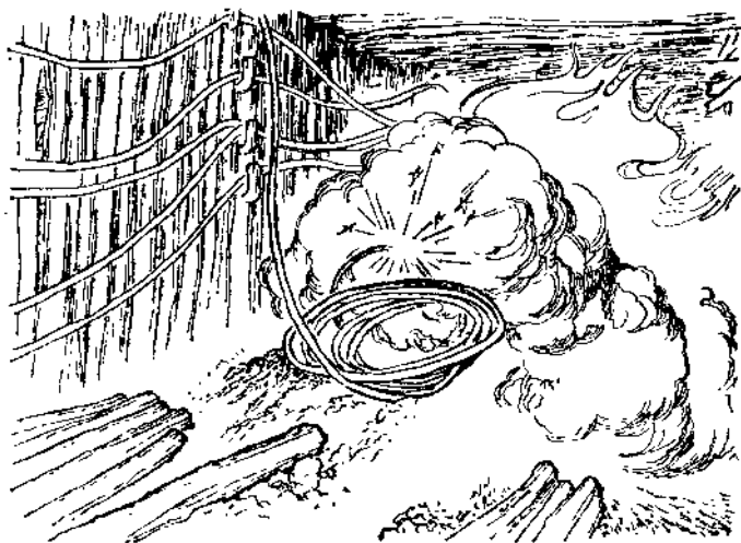
电缆“放炮”引起火灾
