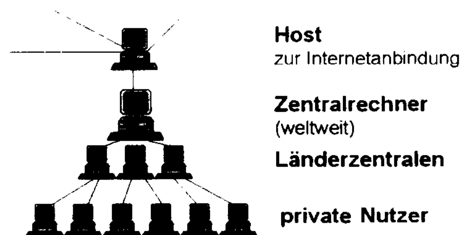
图 2.6 联机服务与因特网的联接结构示意图
