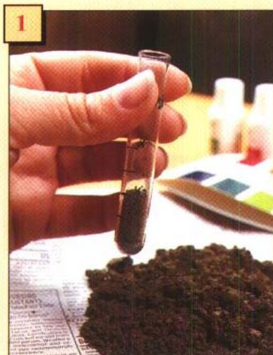
1 从你购得的土壤 pH 值测试包中取出清洁的试管一只，装入 1/4 试管干燥的园土。
