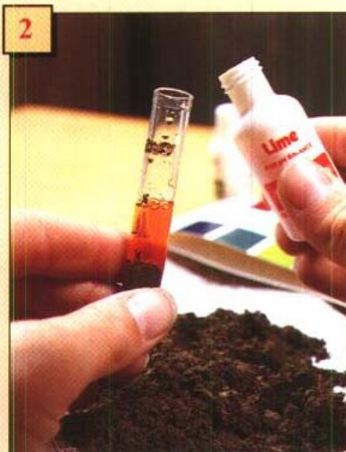
2 添加石灰测试液至试管 1/2 处（或最高至记号处），盖紧试管盖，充分摇匀。
