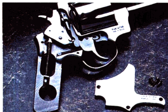
M454 左轮手枪和史密斯-韦森左轮手枪一样，侧板可以卸下。单动/双动的结构也非常相似。
