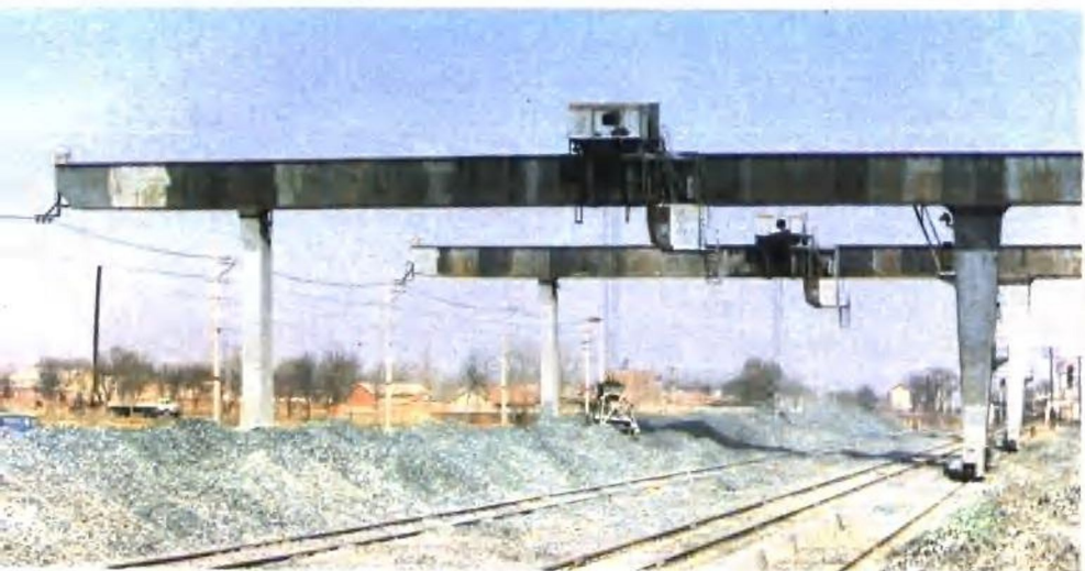
江苏省东海蛇纹石矿的龙门抓斗吊车(10吨、35米跨度)
