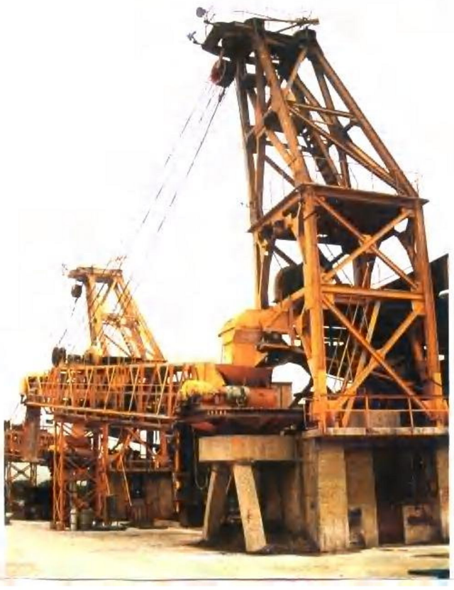
镇江船山石灰石矿 专用码头1200吨/台·时 装船机
