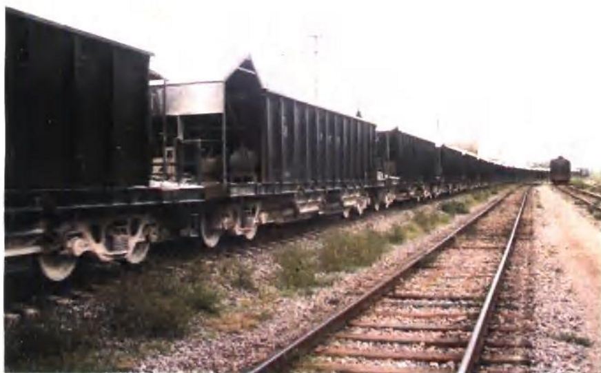
镇江船山石灰石矿专用线60吨K19型底开门自卸车
