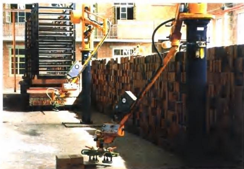
辽宁镁矿耐火材料公司营口耐火材料厂镁白云石砂砖工程 引进的油浸砖生产线
