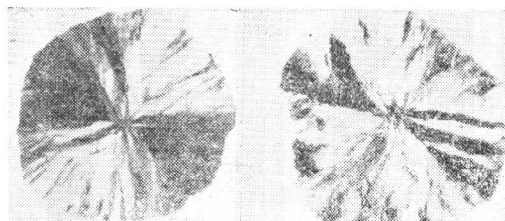
图 19 1500 \times , 铁镬中球墨剖面偏振光图象
