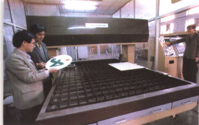
天津市激光研究所1986年安装的1500瓦二氧化碳激光加工机
