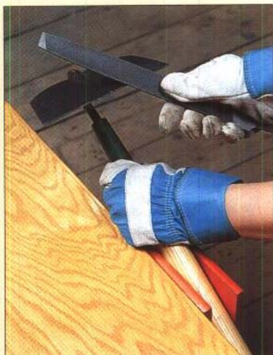
锄头 用手握紧或用夹板钳住锄头柄,用锉刀锉其刀口外缘。
