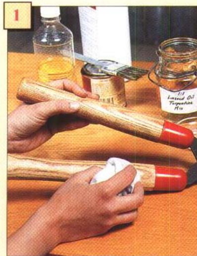
1 春秋用抹布将1:1混合的亚麻油和松节油涂抹木制手柄。
