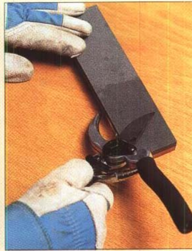
枝剪 把油抹在磨刀石上。顺着刀口沿曲线磨刀,注意仅磨带斜面的一边。
