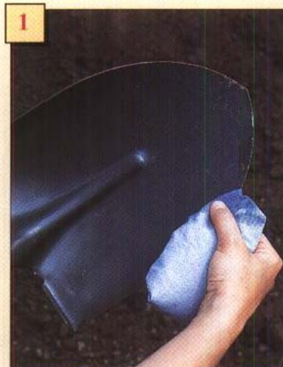
1 圆头锹 用水把圆头锹上的泥土洗净，并用抹布擦干，然后在金属部件上轻轻涂上车用油。
