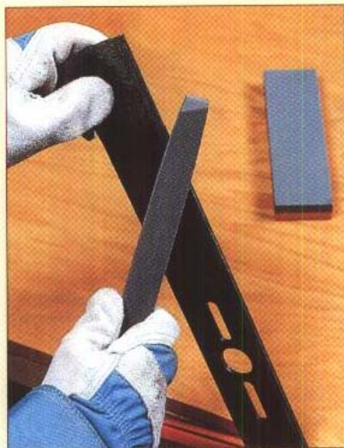
修剪刀片 用夹板钳住刀片,沿自然斜面均匀地锉其刀口。
