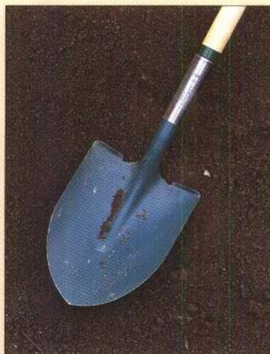
挖掘工具 锻压的金属刀片，坚固的托座和白蜡手柄表明质量不错。
