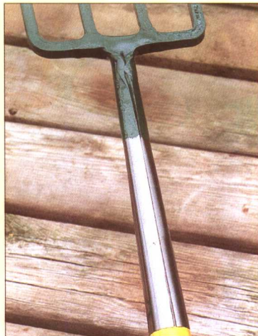
连接刀片与手柄的固定托座或固定金属带结构坚固、耐用。
