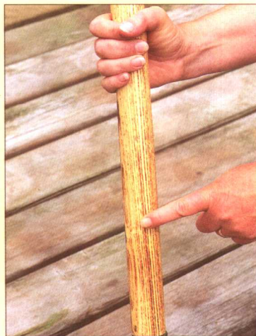
检查木制手柄，其纹理应该通直、清晰、上下均匀、无节点或裂缝。
