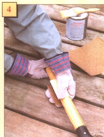
用干抹布擦净手柄，去除粘着的泥土，用砂纸打磨后涂抹密封胶，使手柄光滑。
