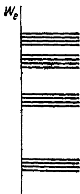
图 1·2 一些（四个）相同的原子紧密结合后的能级图
