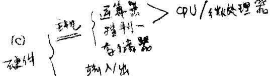
解答：微型计算机硬件系统由微处理器、存储器、输入设备、输出设备组成。微处理器与内存存储器合在一起称为主机；运算器和控制器合在一起称为微处理器或中央处理器。
