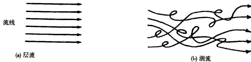
图 1-3 层流和湍流. 图中曲线表示流体质点的路径
