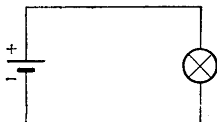
图 1-1 简单照明电路
