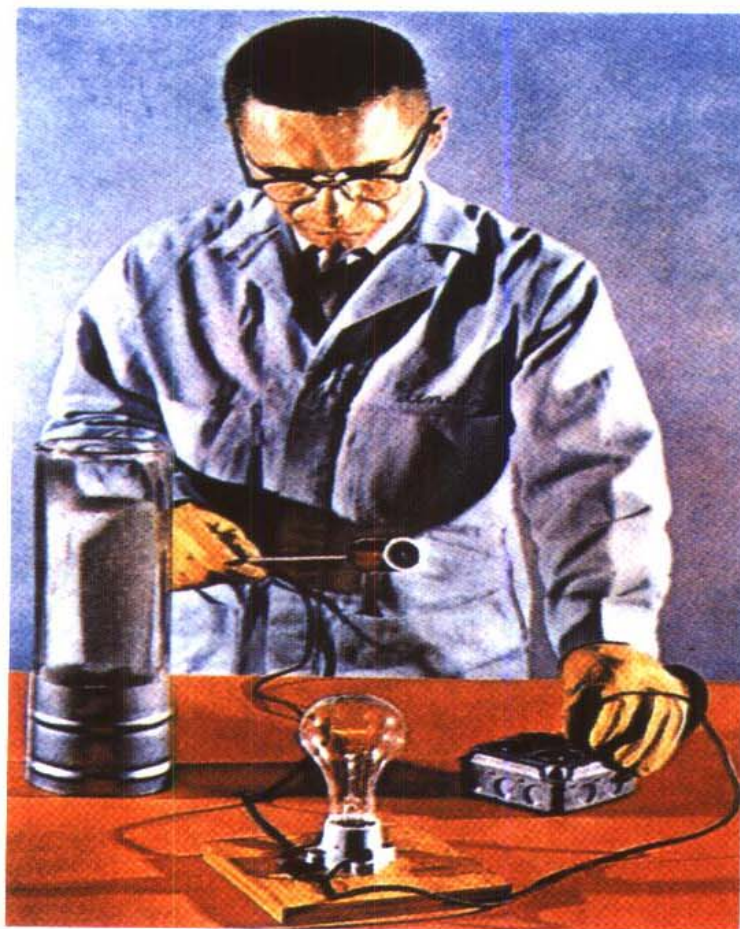
常温下接通电路, 导线绕制的线圈会使电阻增大, 灯泡发出微弱的光 把线圈放入液态氮中, 极低温下电阻突然消失, 灯泡发出强光
