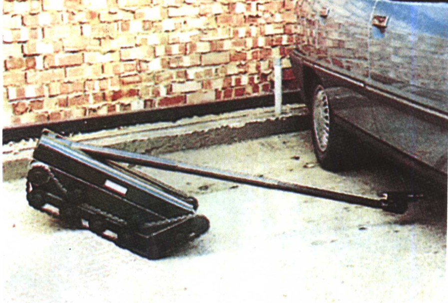
安有电视摄像机的英国“田鼠”机器人,可以方便地探查汽车底部是否安有炸弹
