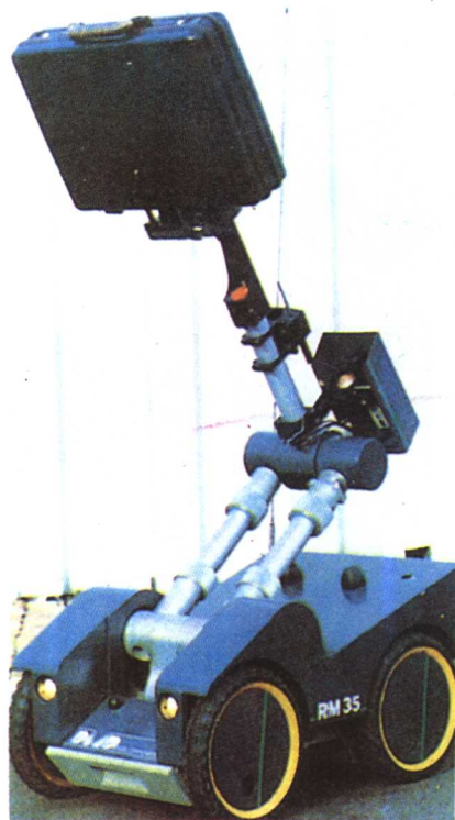
法国RM35型机器人可用于 处理行李中的炸弹
