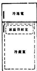
图1—15 有冰温保鲜室的 双门冷藏冷冻箱
