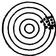
图1-1 精密度高，准确度 不高的打靶记录
