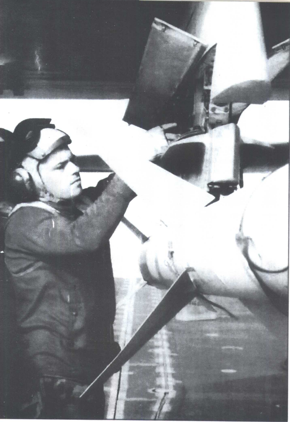
航母军械员正在给EA-6B“徘徊者”飞机安装AGM-88型高速反辐射导弹。（美国海军提供）
