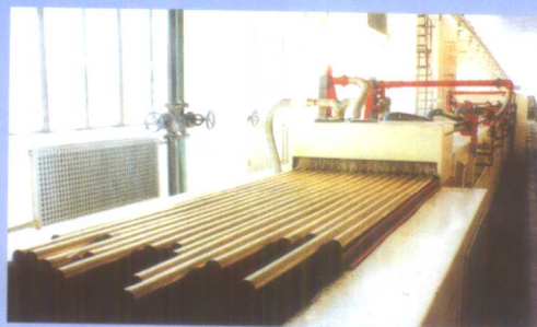
从美国S.M公司引进的网带式全连续光亮退火炉在工作
