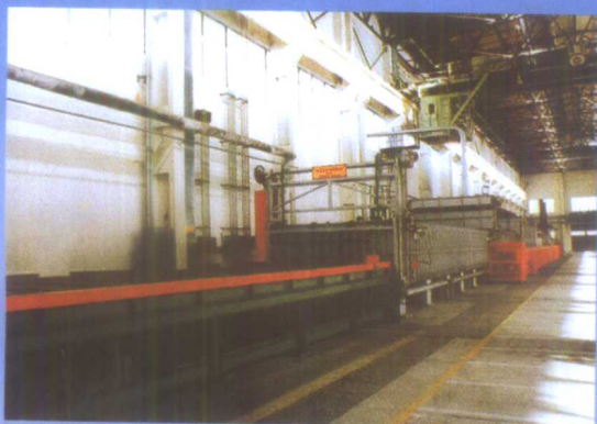
意大利olivotto公司制造的具有真空锁气室、多段控制、高纯度保护性气氛等特点的辊底式光亮退火炉
