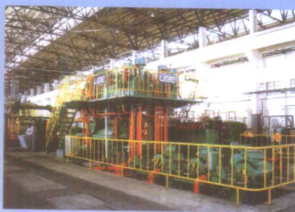
日本UBE制造的1800UST液压挤压机,具有自动对中检测、针内冷、水封挤压、预应力张力柱、内置、双动、滑移模架、自动换模、MDI控制等性能和结构特点
