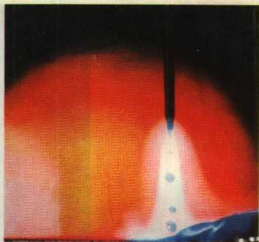
高速摄影机摄下的惰性 气体保护电焊
