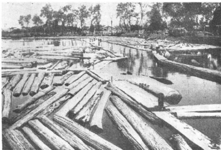
嘉义貯木池 嘉义市为台湾最大的制材中心，有規模宏大的制材工厂，原材由阿里山林区供应。圖为制材工厂所屬的貯木池，占地广达五十余万平方公尺。木材先由火車自林場下运，集中貯存此处，然后送入工厂加工或外运。（新华社圖稿）
