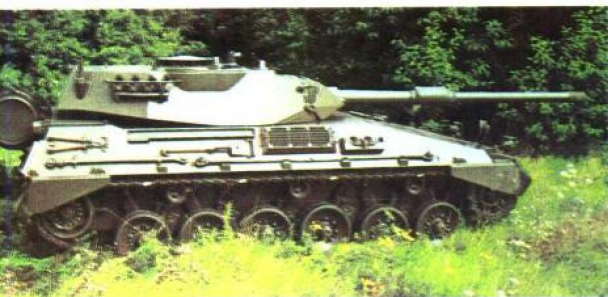
上图:TAM中型坦克的作战距离为550km,车体后加装附加长程油箱后可以增至900km。TAM坦克基本上是以貂式机械化步兵坦克的车体和安装在车体后方的1具新型炮塔和1门105mm炮。
