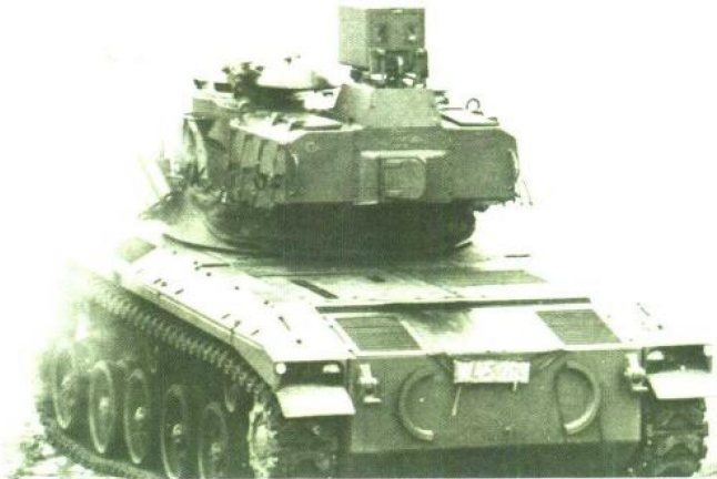
上图:1 辆 Panzerjäger K 正在发射 105mm 炮。空弹壳由炮塔后的 1 个门弹出。
