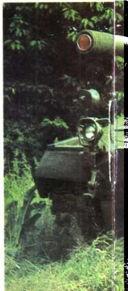
上图:TAM中型坦克的作战距离为550km,车体后加装附加长程油箱后可以增至900km。TAM坦克基本上是以貂式机械化步兵坦克的车体和安装在车体后方的1具新型炮塔和1门105mm炮。
